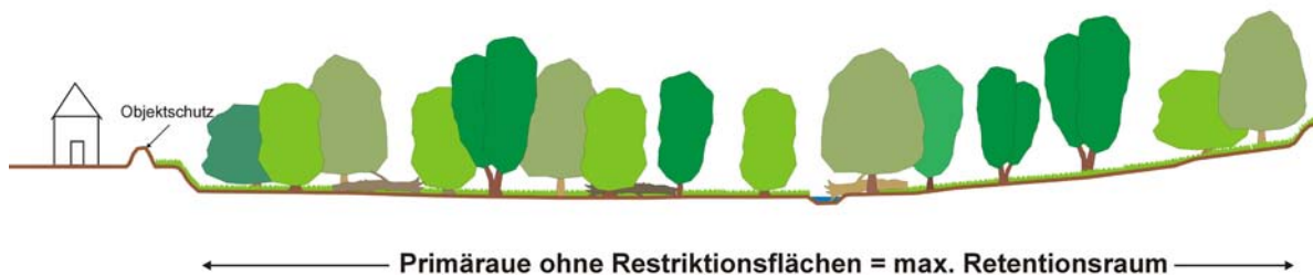
Abb. 100: Schematische Darstellung der Reaktivierung einer Primäraue (Quelle: PLANUNGSBÜRO KOENZEN 2010) Es handelt sich um die weitreichendste Maßnahme der Gewässerentwicklung. Sie ist wegen der vorherrschenden Flächennutzungen zumeist nur kleinräumig möglich.
