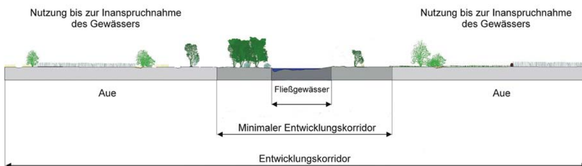
Abb. A.2: Schematische Darstellung zur Lage und Ausdehnung des Entwicklungskorridors (Quelle: PLANUNGSBÜRO KOENZEN 2010)
